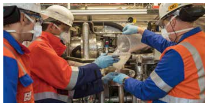
Die Forscherinnen und Forscher von RWE betreiben in Niederaußem unter anderem einen Teststand zur Synthetisierung von CO 2 und Wasserstoff zu Chemiegrundstoffen und Treibstoffen.
