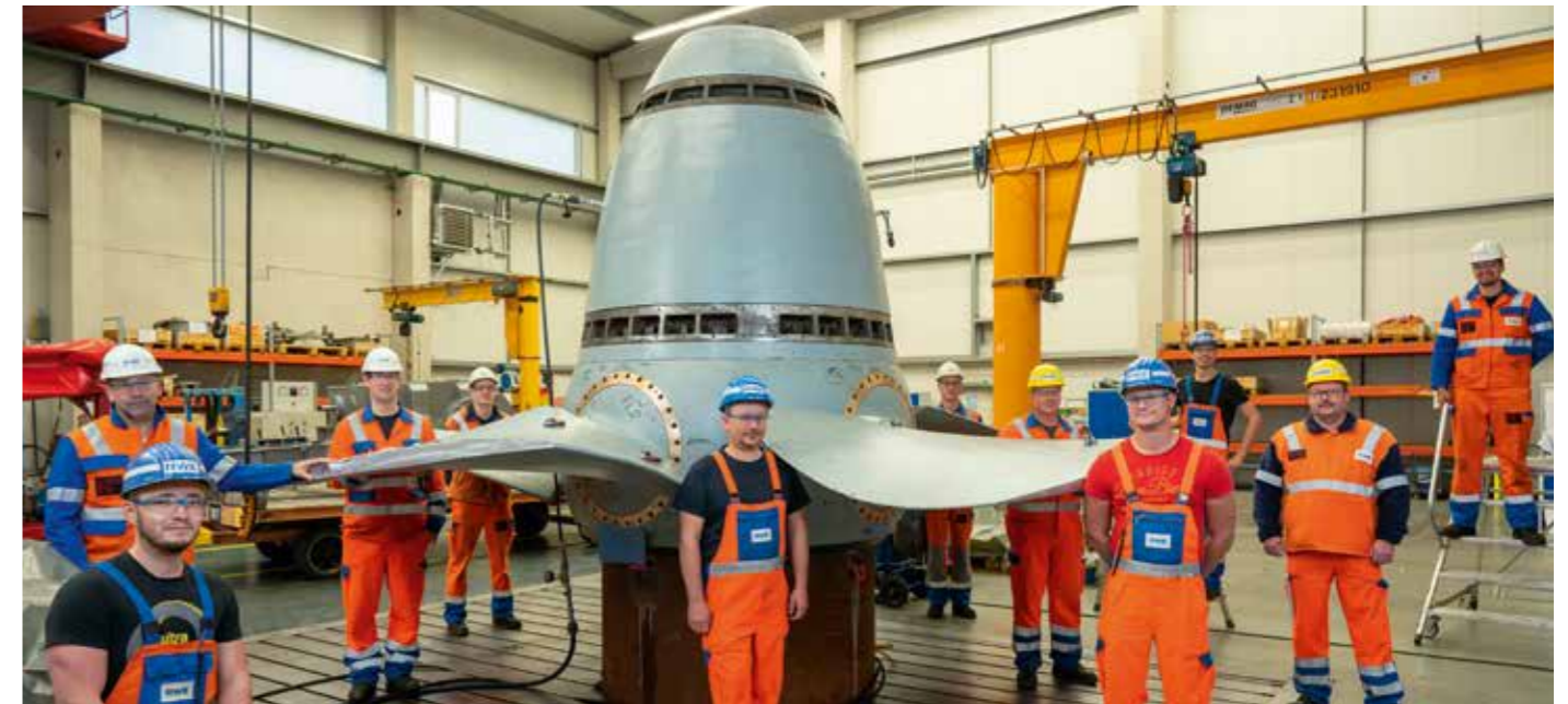
Ein Team der RWE-Hauptwerkstatt Grefrath setzte ein beschädigtes Laufrad des RWE-Laufwasserkraftwerks Fankel/Mosel instand.
